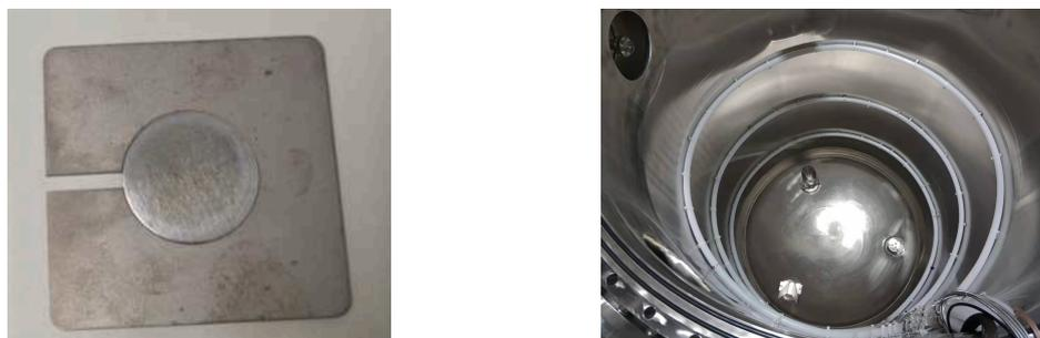
图 2.17 左：镀在不锈钢上的  $^{228}\text{Th}$  源。右：固定在探测器外罐内壁上的刻度管，可以放胶囊大小的标定源，如  $\text{AmBe}$ ,  $\text{PuC}$ ,  $^{137}\text{Cs}$ ,  $^{252}\text{Cf}$ 。
