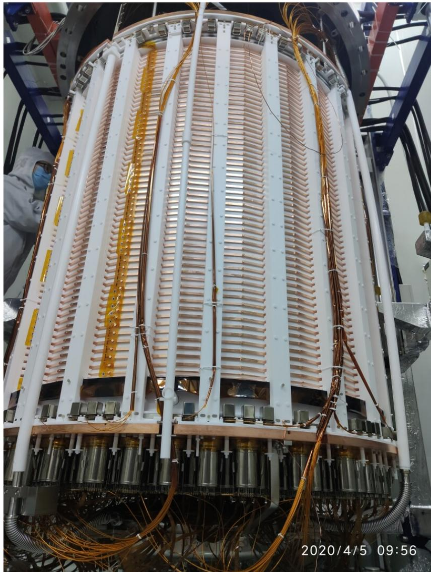
图 5-4 PandaX-4T 光电探测系统和时间投影室实物图。
