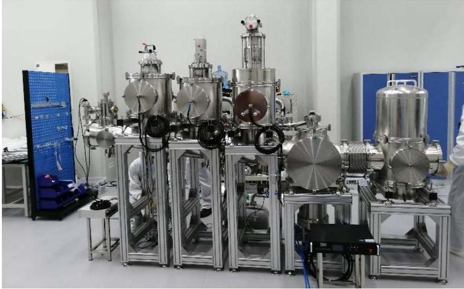
图 5-8 PandaX4T 制冷系统组装实物图。
