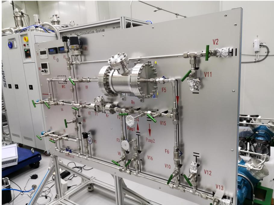
图 5-16 内源刻度注入控制面板。 $^{83}\text{Rb}$  和  $^{228}\text{Th}$  源置于两组气体管路的腔体中，被流动的氦气带入探测器内。
