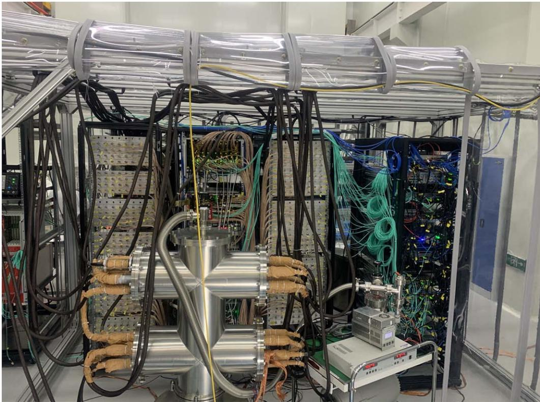
图 5-23 PandaX-4T 读出电子学和 DAQ 硬件设备现场实物照。整个系统包括两个用于安装新版信号解耦器的机柜(左起第一、第三个)、一个用于安装数字化波形采集卡阵列的 VME 机箱的机柜(左起第二个)和一个服务器机柜(最右侧)。正前方为 PMT 信号引出线的大法兰。图片摘自<sup>[180]</sup>。
