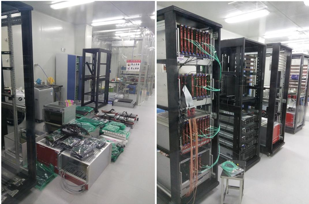
图 5-51 左图，电子学各设备刚运至现场万级洁净间。右图，从左只有依次为 VME 机柜、服务器机柜、两台高压机柜。
