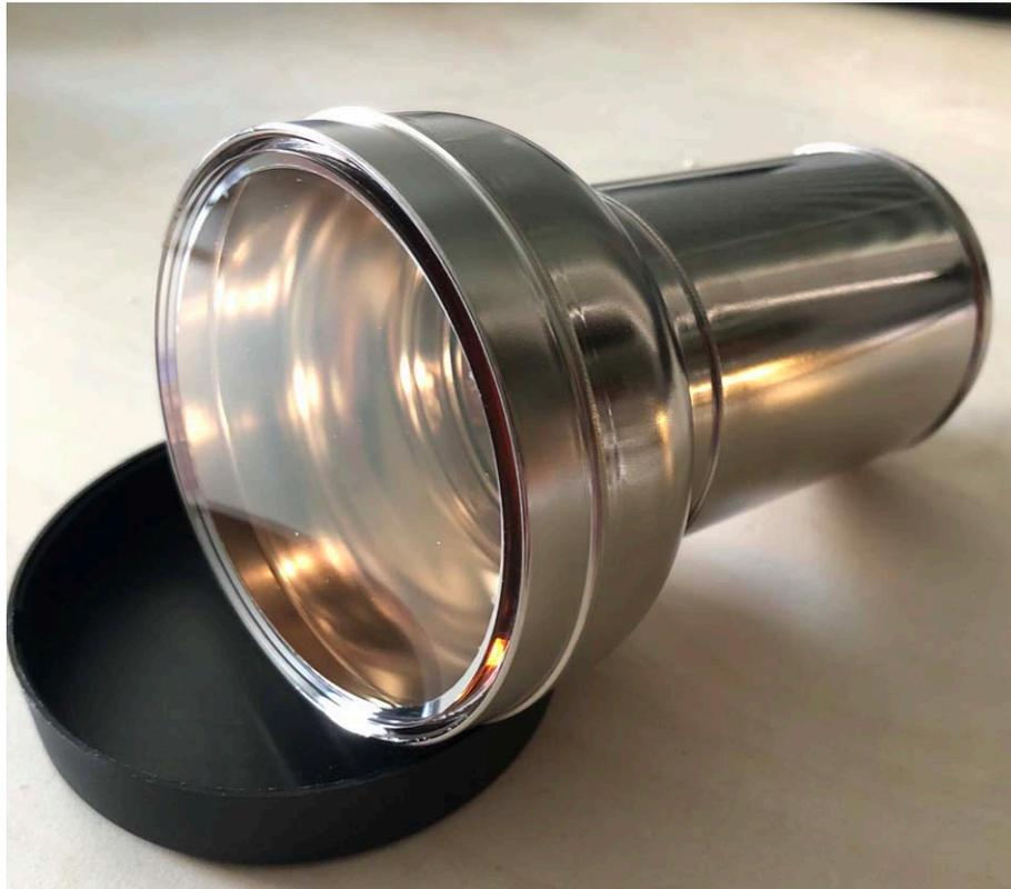
图 5-24 PandaX-4T 暗物质直接探测实验所用到的滨松 3 英寸 R11410-23 光电倍增管。其石英玻璃窗直径 76 mm，外壳前后长 114 mm。
