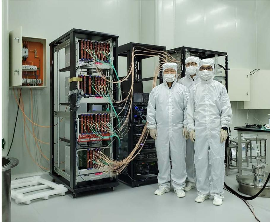
图 5-52 电子学设备移到水罐位置重新搭建后进行各项测试。最左侧为 VME 数据采集机柜，中间为服务器机柜，左右侧为信号解耦器和高压机箱。图中前排左一为本文作者的导师，电子学课题组负责人，左二为同一课题组的研究生，后排中间位置为本文作者。
