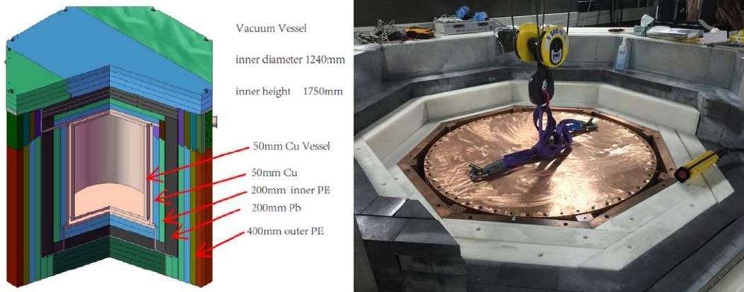
图 3-13 左图，PandaX-II 实验屏蔽体结构示意图。右图，屏蔽体实物图。
