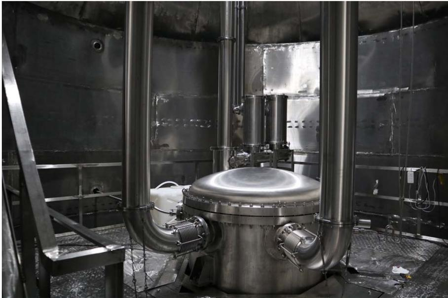
图 5-7 PandaX4T 探测器外罐和“L”型外真空管路以及热交换模块。
