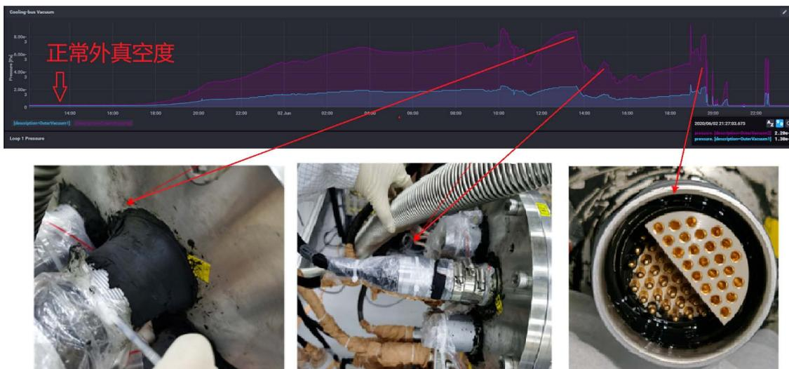
图 5-50 用于 PMT 高压通路上的 LEMO 转接头泄露导致外真空的改变造成的打火。PandaX-4T 实验中用于光电倍增管正高压供电的线路和信号线路为同一根线缆，从 TPC 内罐引出来的信号线，要经过外真空层再到电子学，LEOM 48 针转接头连接 PMT 大法兰上外真空腔体内外的高压线。转接头泄露将直接改变外真空腔体的真空度，LEMO 接头的插针为密集排布，最终导致了整个一组 LEMO 线缆发生打火。上图为慢控页面外真空度的监测数值随时间的变化趋势，下面三幅图发现泄露后进行的三次堵漏的尝试，最左边是直接真空封泥堵转接头与法兰接触面，中间的图中尝试用塑料密封袋包裹，最右侧图中，尝试用环氧树脂 (epoxy) 将转接头内部进行密封，最终将微漏堵住。
