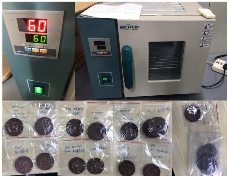
图 5-28 用于烘烤 PMT 分压器 PCB 板的烤箱以及部分经过挑选后的残次品。左上为测试中的烤箱，温度被设定为 60°C，总共测试时间持续 72 小时，右上较为冷却状态的烤箱，下方为烘烤以后经万用表以及外观检测后挑出来的残次品。
