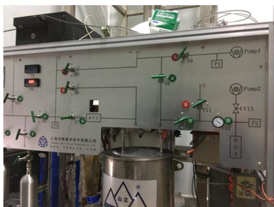
图 6-3: 离线氡含量测量系统
