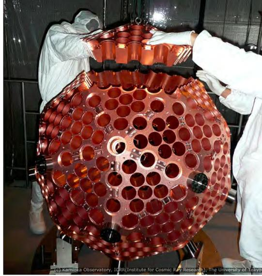
图 1-22: XMASS 探测器 [15]
