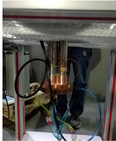
(b) 制冷机测试系统内部图
