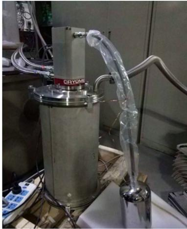
(a) 制冷机测试系统外部图
