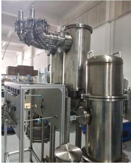
图 4-11 循环系统热交换模块实物图
