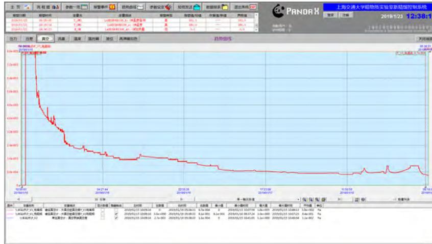
图 6-17 预冷阶段外真空变化图
