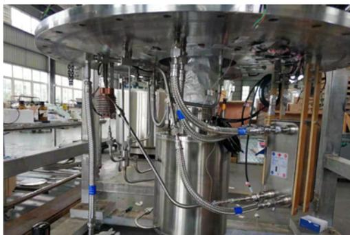
图 6-2 精馏系统真空罩中板式热交换器安装图
