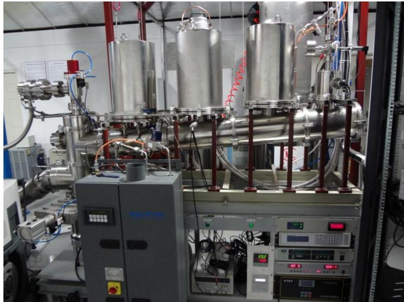
图 2.6 PandaX-I探测器的制冷系统，前面是循环提纯系统的气体纯化器(Getter) 装置<sup>[8]</sup>
