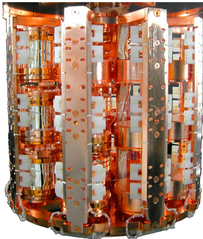
图 1.12 位于容器内的CRESST 所有探测模块(CRESST实验网站)
